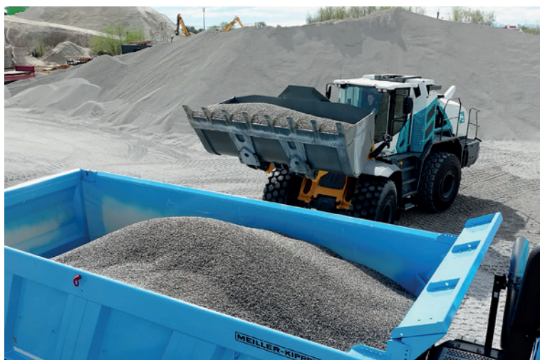
Bild 2: In einem Kieswerk bei München belädt der mit Wasserstoff betriebene Radlader effizient und leistungsstark einen H 2 -Lkw.
