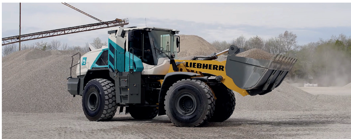
Bild 1: Der L 566 H ist der erste Prototyp eines Liebherr-Großradladers mit Wasserstoffmotor.
